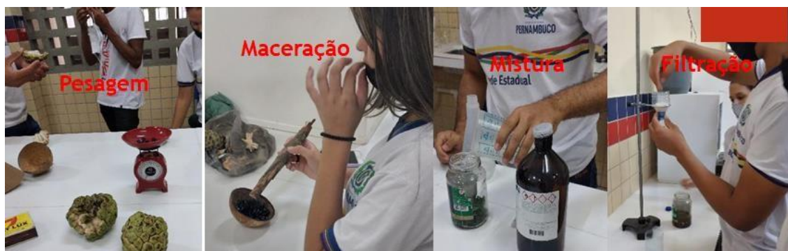
Figura 12. Etapas experimentais para extração de óleos essenciais.
