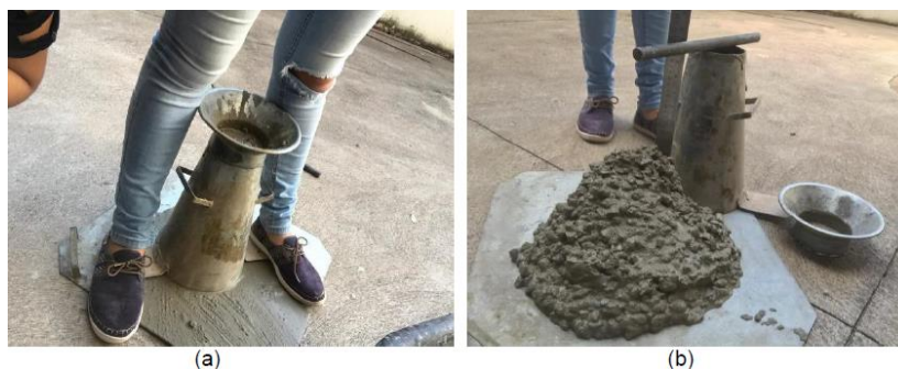
Figura 3: Ensaio de Abatimento de Tronco
