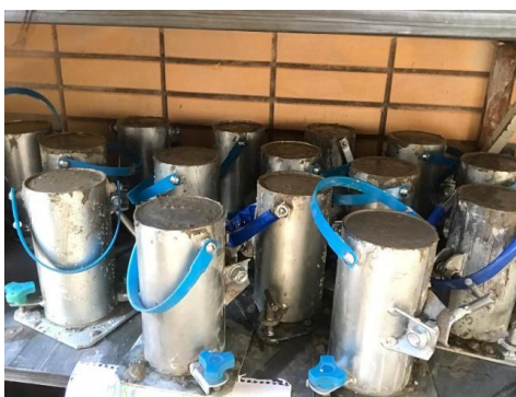
Figura 4: Moldes com Concreto Fresco
