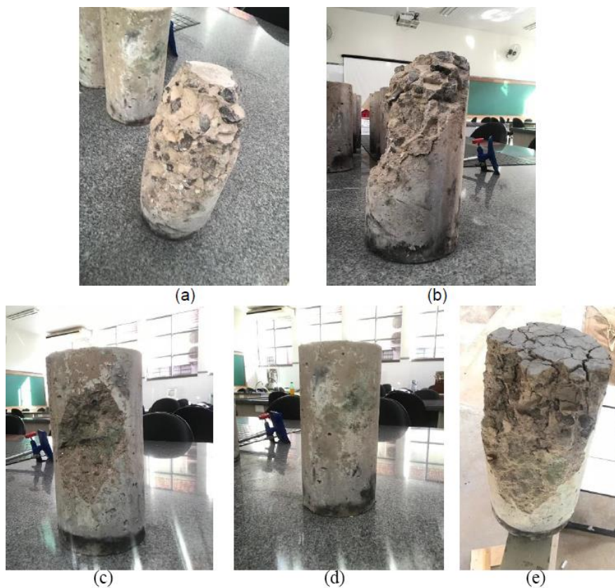
Figura 12: Corpos de Prova Grupo 4 (12 horas)
