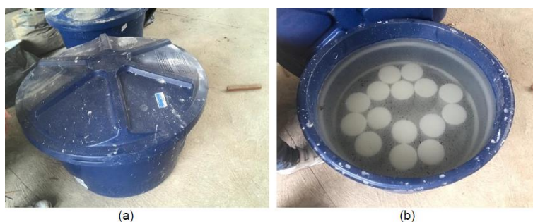
Figura 5: Corpos de Prova em Cura Submersa
