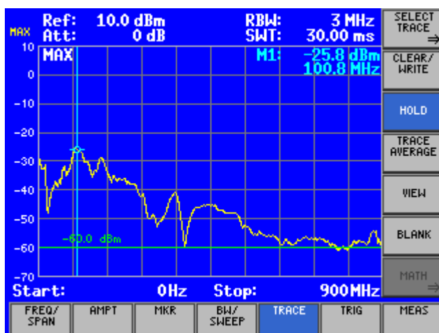
Figura 7: Medida do espectro do sinal irradiado pelo circuito gerador de pulsos.
