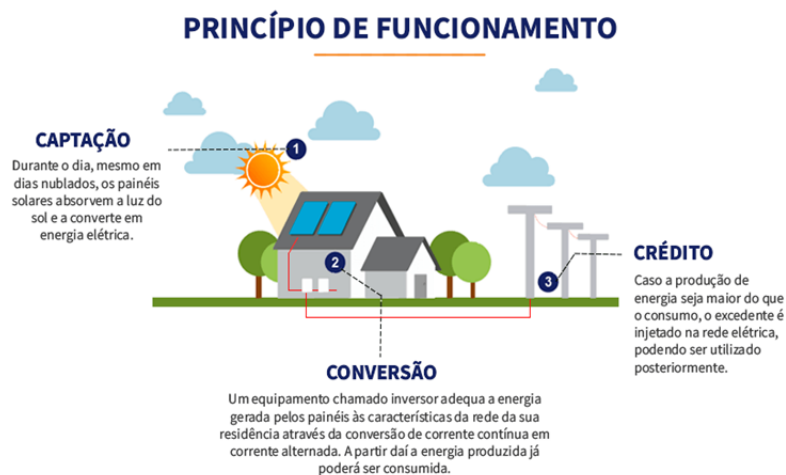
Figura 1. Princípio de funcionamento de um sistema fotovoltaico
