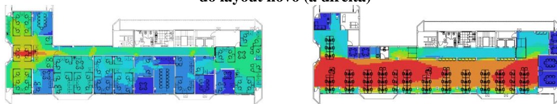
Figura 7 – Mapa de conectividade do layout atual (a esquerda) e mapa de conectividade do layout novo (a direita)
