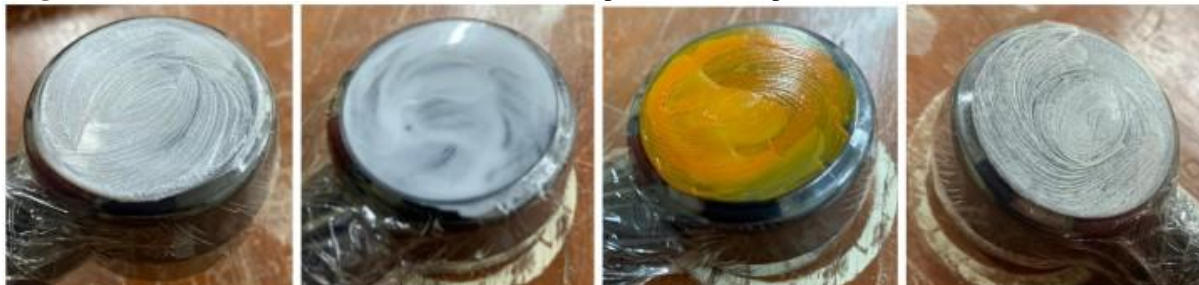
Figura 3 - Camada 1 dos filtros caseiros 1, 2, 3 e 4, respectivamente, aplicadas sobre o sensor do medidor UV.
